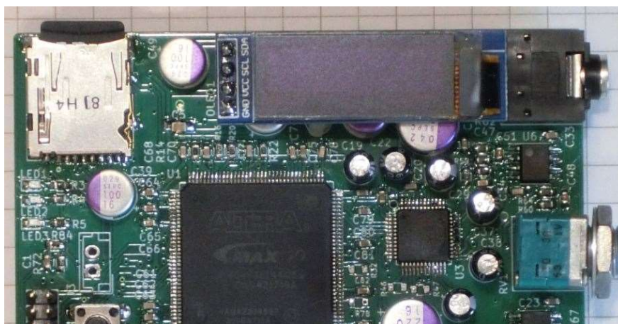
写真 3. OLED および microSD カード実装状態
