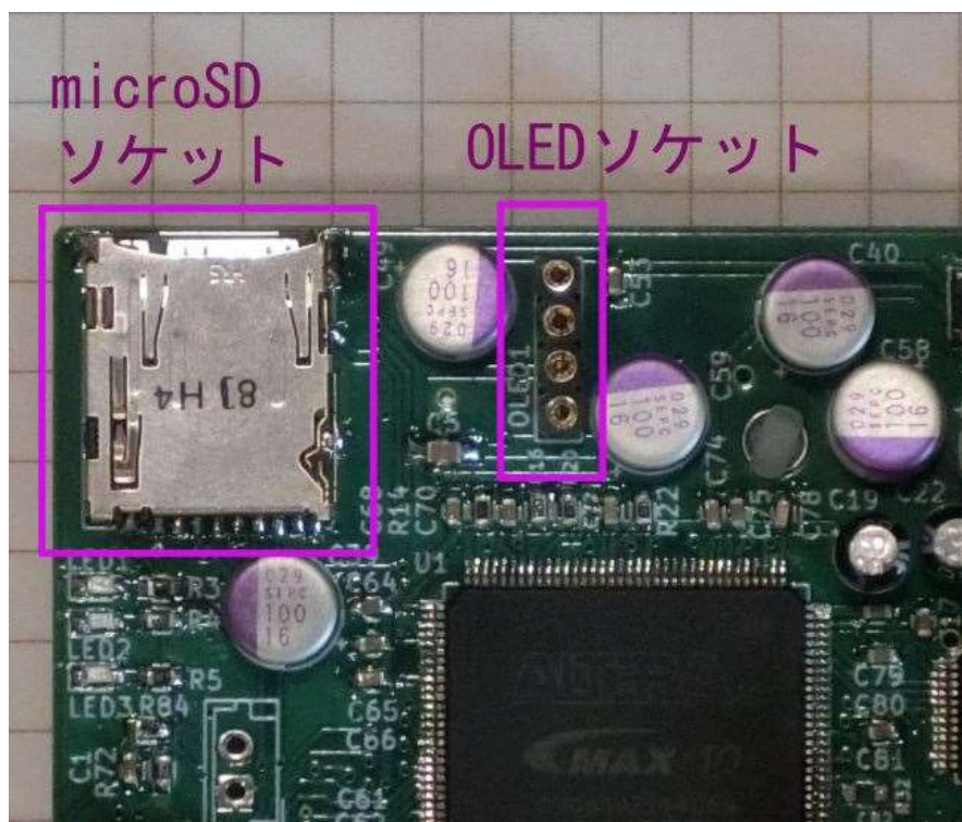
写真 2. OLED ソケットおよび microSD カードソケット
